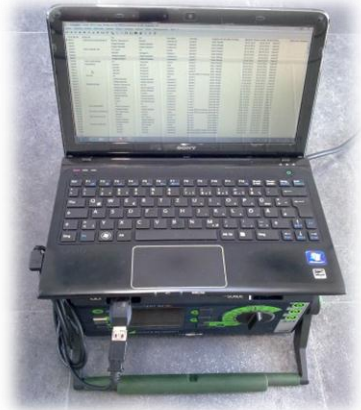
Messgerät an Notebook mit gerichtsbeständiger Prüfsoftware Bildquelle: MPS Elektrotechnik GmbH
