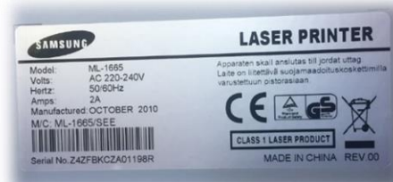
Beispielhaftes Typenschild Bildquelle: MPS Elektrotechnik GmbH
